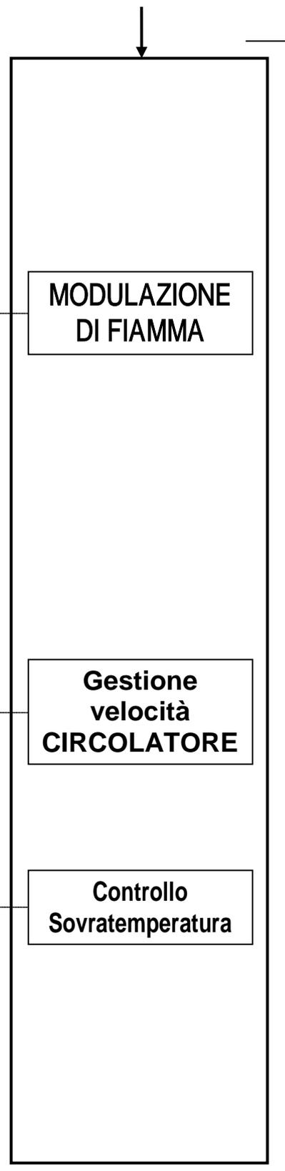
**N.B.** A partire dalla richiesta riscaldamento, rimane sempre attivo il controllo della “temperatura limite” (88°C, valore fisso non regolabile) effettuato dalla sonda di uscita scambiatore primario (NTC 1).
